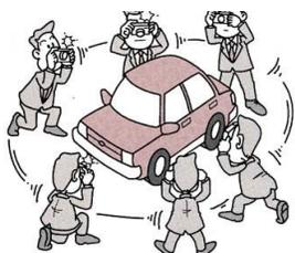
損傷箇所とカメラを同じ高さにして撮る。
